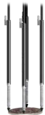
使用6 毫米外径探头检测硬币厚度的应用
